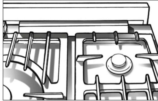
Der Abstandhalter gewährleistet einen Abstand von 70 mm zwischen Wand und Gerät. Die Gesamttiefe des Geräts (ohne Handlauf) beträgt dann 720 mm. Der Abstandhalter schafft optimale hitzetechnische Rahmenbedingungen und ist besonders in Verbindung mit Gasbacköfen sehr empfehlenswert. Er macht außerdem die Geräterückseite für Reinigungszwecke besser zugänglich.
